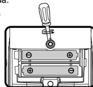
4. Coloque 2 pilas AAA (AM-4/LR03) nuevas según muestra el dibujo. Se recomienda el uso de pilas alcalinas para un mejor rendimiento del aparato.
