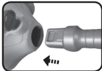
3. Inserte la cubierta de la rueda delantera en la parte delantera de la scooter. Presione hasta que escuchen las pestañas de la cubierta encajar en su lugar.
