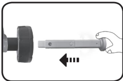
9. Por favor, compruebe los bloqueos antes de usar la scooter. Los bloqueos estarán en la posición de bloqueo cuando los ejes estén correctamente instalados
