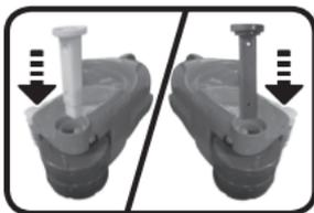
7. Para quitar las ruedas traseras, deslice y sostenga el bloqueo de las ruedas mientras extrae el eje corto. Después, repita extrayendo el eje largo para poder sacar y separar ambas ruedas.
