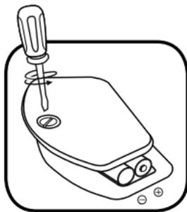
5. Coloque de nuevo la tapa y cierre el compartimento, asegurándose de que el tornillo está suficientemente apretado.
