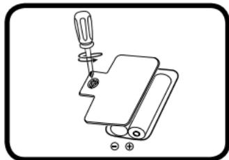
4. Coloque 2 pilas AAA (AM-4/LR03) nuevas según muestra el dibujo. Se recomienda el uso de pilas alcalinas para un mejor rendimiento del aparato.
