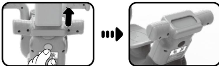
**Puerta de bloqueo:** Empuje hacia abajo la cerradura delantera para abrir la puerta de bloqueo (como se muestra) e inserte el asa en la ranura. Cuando oiga un click, estará correctamente ajustado.
