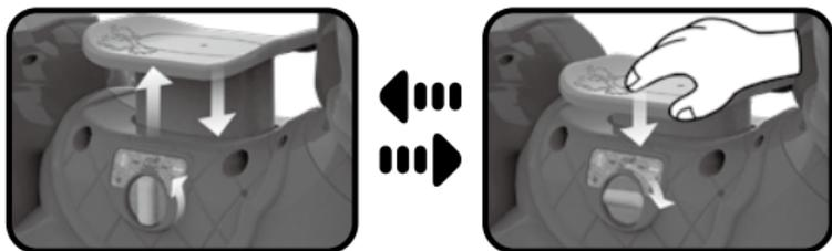
**Bloqueo de ruedas:** Si las ruedas están bloqueadas, gire el bloqueo 90° en sentido a las agujas del reloj para desbloquear las ruedas. Su hijo podrá montar o mover el poni hacia delante y hacia atrás. Si las ruedas están desbloqueadas, gire el bloqueo 90° en sentido contrario a las agujas del reloj para evitar que el poni se mueva hacia atrás.
