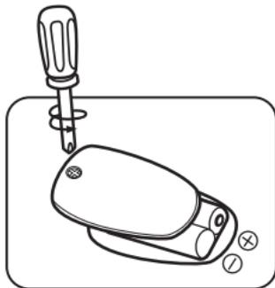
5. Coloque de nuevo la tapa y cierre el compartimento, asegurándose de que el tornillo está suficientemente apretado.
